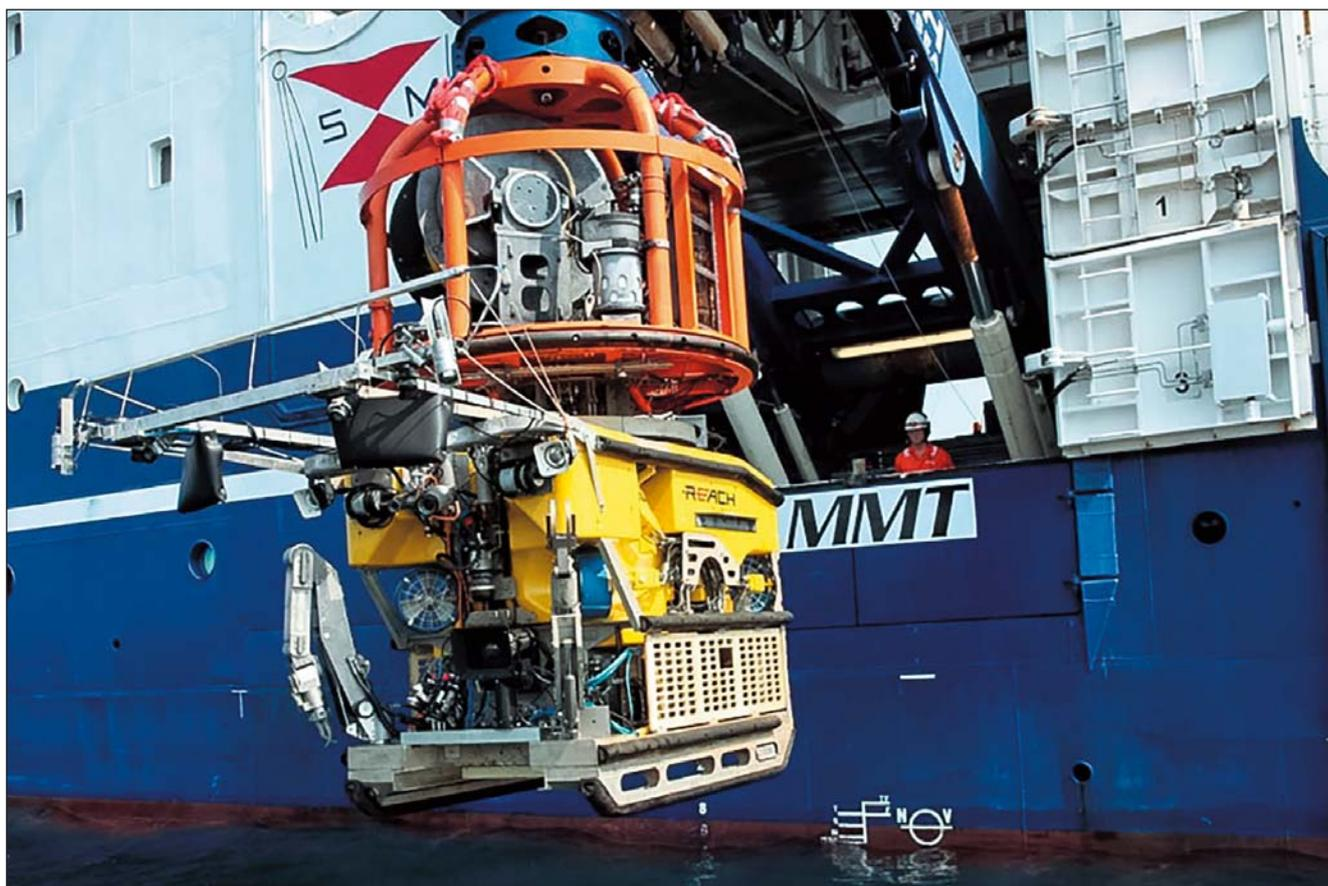
Messa a mare di uno ROV *Surveyor Interceptor* configurato con molteplici apparecchi di rilievo e attrezzatura da lavoro
